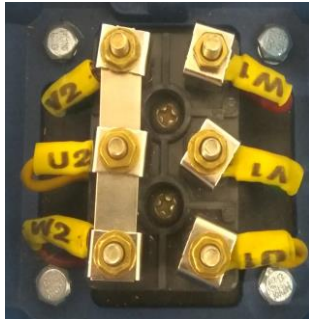
Рис.3. Соединение обмоток мотора по схеме «звезда»
