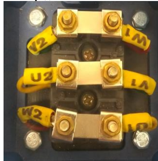
Рис.4. Соединение обмоток мотора по схеме «треугольник»
